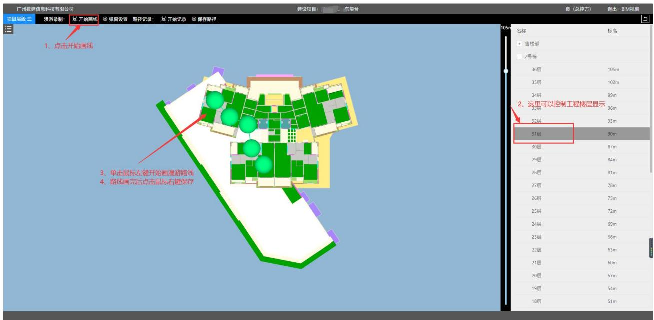
操作：点击‘开始画线’-->选择需要漫游的工程楼层-->在模型上点击鼠标左键绘制路线-->绘制完成后点击鼠标右键保存。
